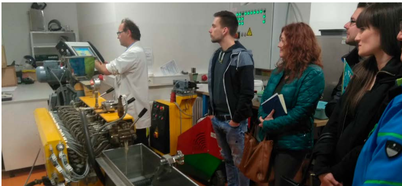
Pred. Silvester Bolka med prikazom delovanja naprave dvopolžnega ekstruderja
