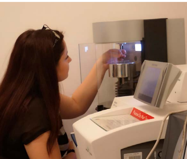
Katja Hrbinič med delom na aparaturi za merjenje tenziometrije - površinske napetosti
